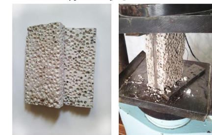
Рис. 3. Характер разрушения силикатных материалов с АГЗ на упрочненных кладочных растворах
