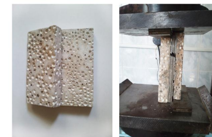
Рис. 2. Характер разрушения силикатных материалов с АГЗ на кладочных растворах традиционных составов
